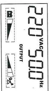
Рисунок 5-3 Режим работы от аккумулятора
